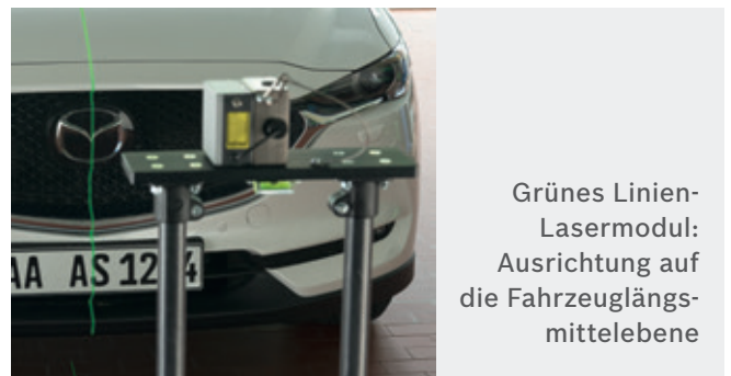
Höheneinstellung zum Boden durch Lasermodul
