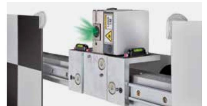
Linien-Lasermodul am Präzisionsmessbalken
